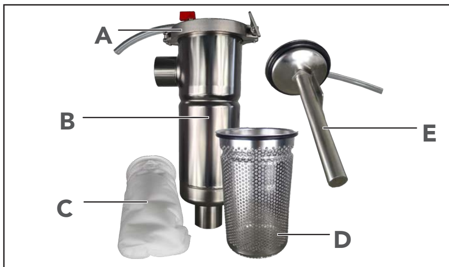
Bild 3-7: Der Dualfilter im demontierten Zustand
