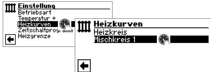
Der Bildschirm wechselt in das Menü „Heizung Heizkurve MK1“. Die Heizkurven können programmiert werden, sofern keine Festtemperatur definiert ist.
