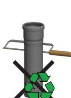
Abb. 4: Innenrohr kürzen
