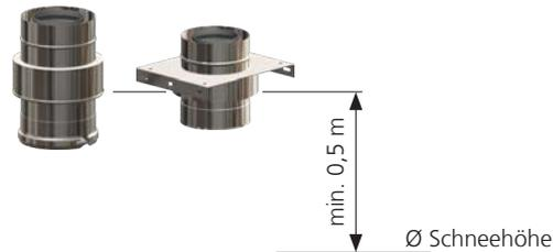
Abb. 8: Zuluftöffnungen freilassen!
