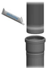
Abb. 1: PP-Rohrende einfetten
