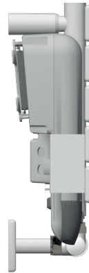
Abb. 2: Seitenansicht Heizkörper + Gebläse
