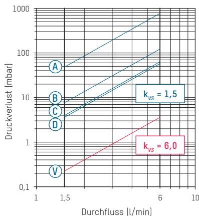
A – D Rücklaufkennlinien Ventilposition TacoSetter Inline 130
